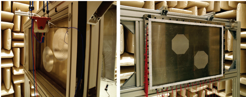
Abbildung 5.16: Prüfstand für ASL-Platte im reflexionsarmen Raum am DLR in Braunschweig
