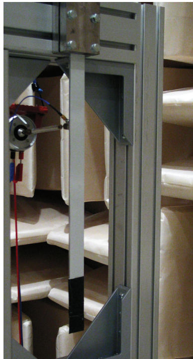
Abbildung 4.3: Versuchsaufbau mit Balkenaufnahme und Shaker, hier ASL-Balken quadratisch mit Schaumstoff und Klebeband als Dämpfungsvariante
