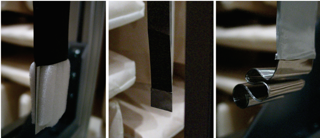
Abbildung 4.4: Verschiedene Dämpfungen im ASL; Links: Schaumstoff mit Klebeband (hier offengelegt); Mitte: 25 mm CLD; Rechts: Eingerolltes CLD 100 mm
